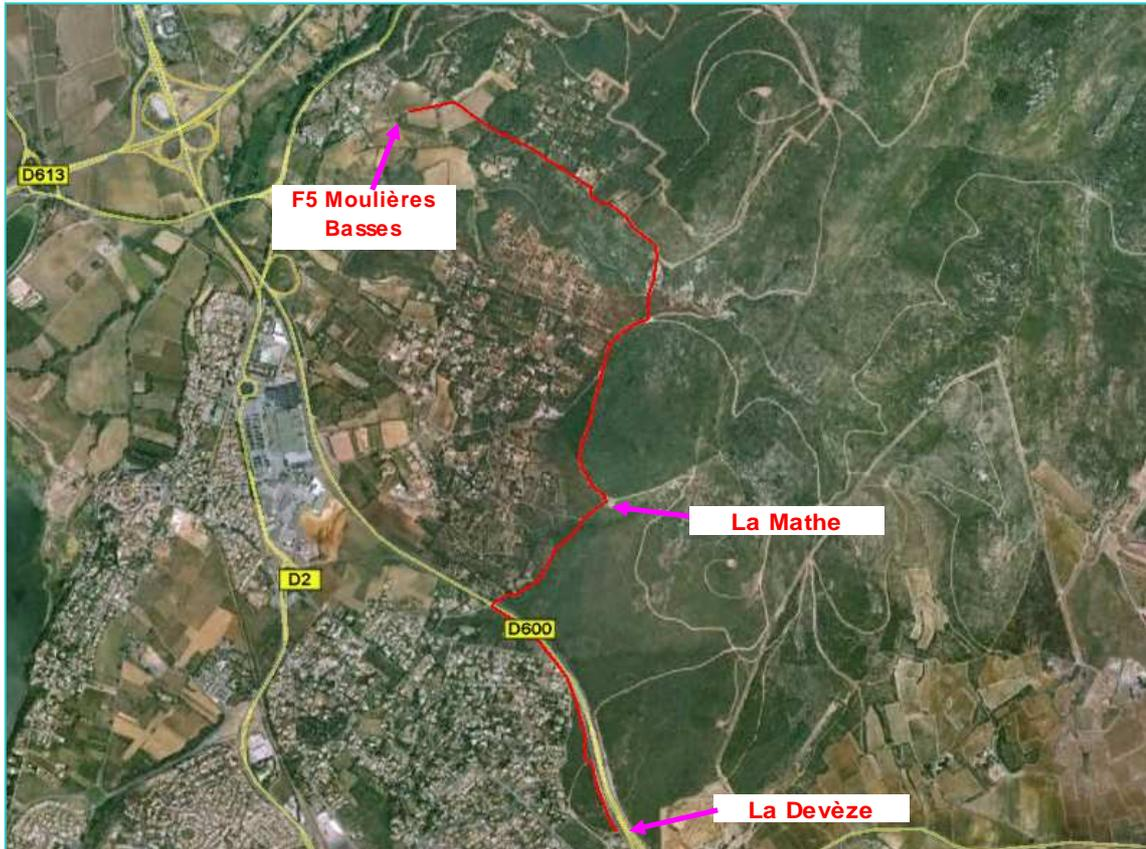
3,9 Km de conduite en fonte DN 250 mm seraient nécessaires pour ce second tracé. Le coût de l'opération est évalué à 1,01 M€HT hors imprévus et maîtrise d'œuvre.
