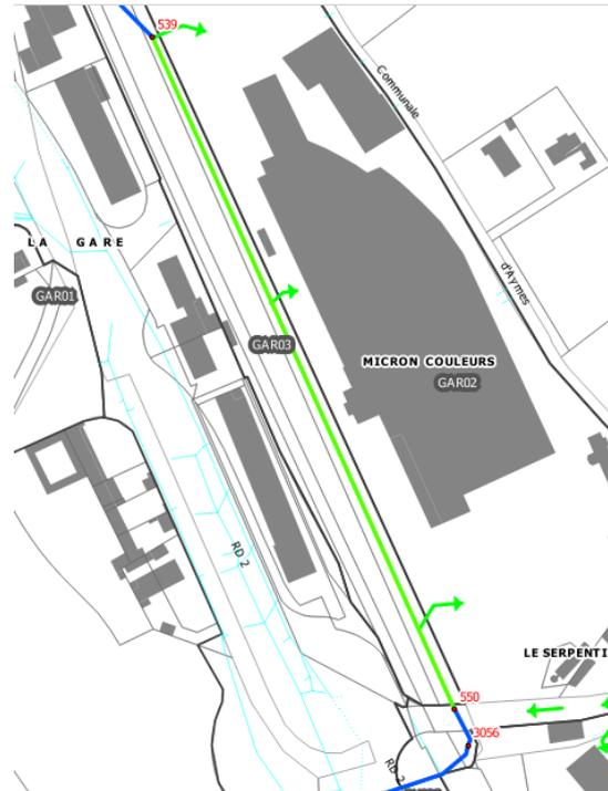
*Insuffisance du réseau pluvial et sens d'écoulement des débordements (vert) – secteur de l'ancienne gare*
