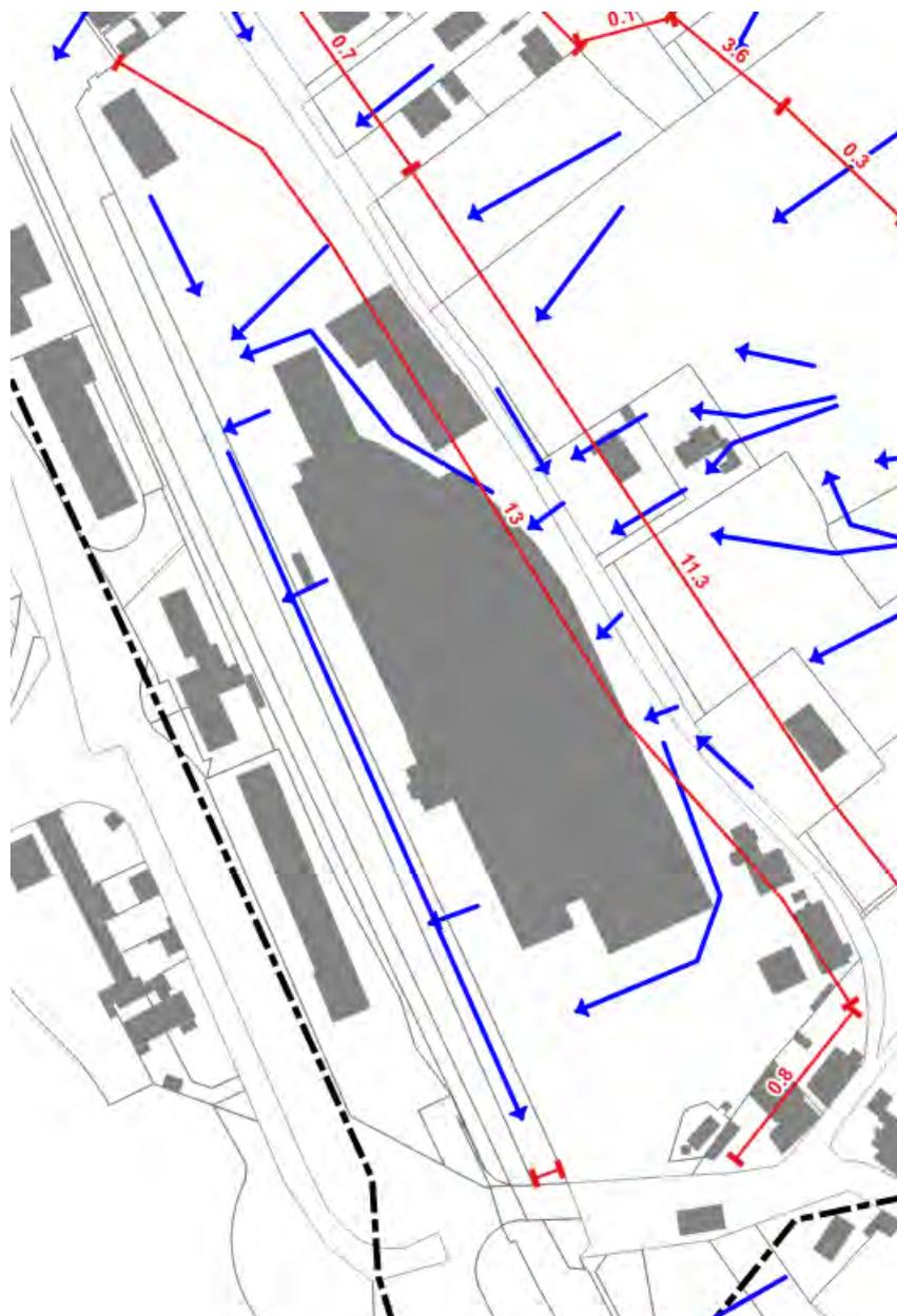
*Axes d'écoulement et débits au droit de SIBELCO*
