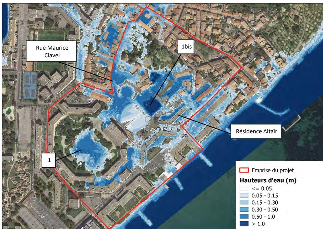
**Illustration 62 : Hauteurs d'eau maximales et sens des écoulements pour l'évènement centennal en situation existante au droit du projet**
