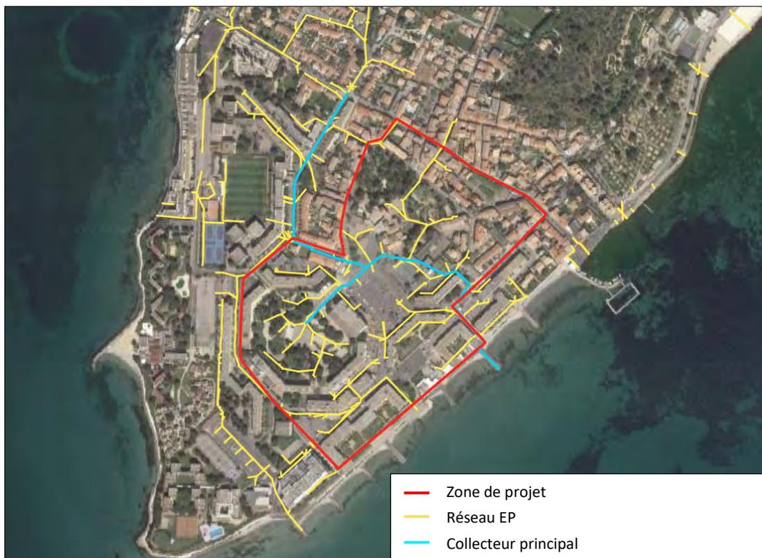
**Illustration 18 : Lever du réseau de collecte des eaux pluviales
