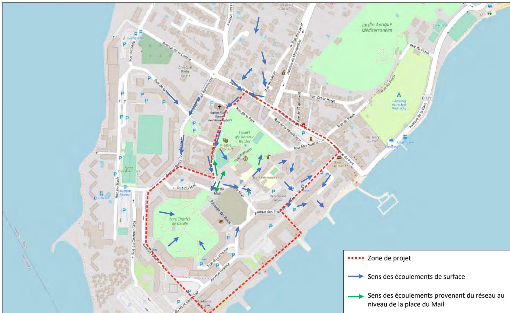
Illustration 61 : Principaux sens d'écoulements des eaux au droit du Cœur de Station
